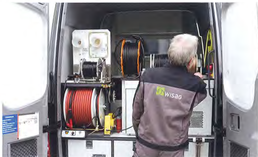
Wisag nutzt einen neuen Kabelmesswagen zur Fehlerortung und Diagnose im Stromnetz.
